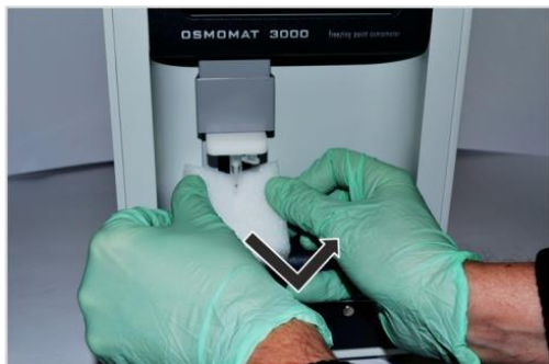
Obr. 15: Vyjmutí transportní ochrany
